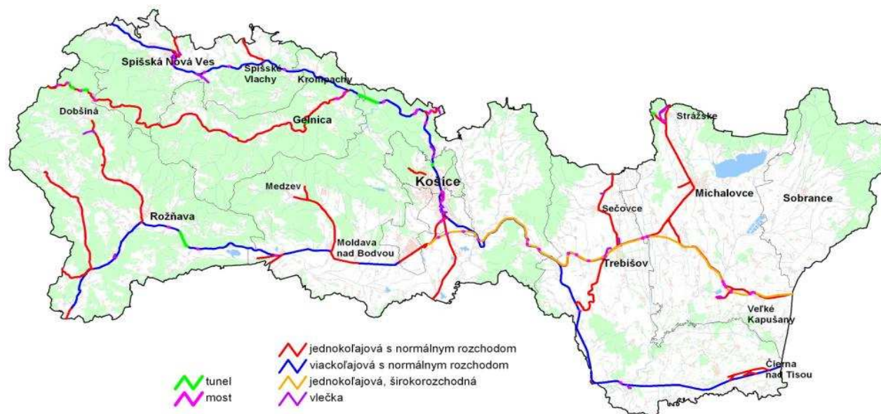
Obrázok č. 6 : Rozdelenie železničných tratí v Košickom kraji podľa koľajnosti a rozchodu.
